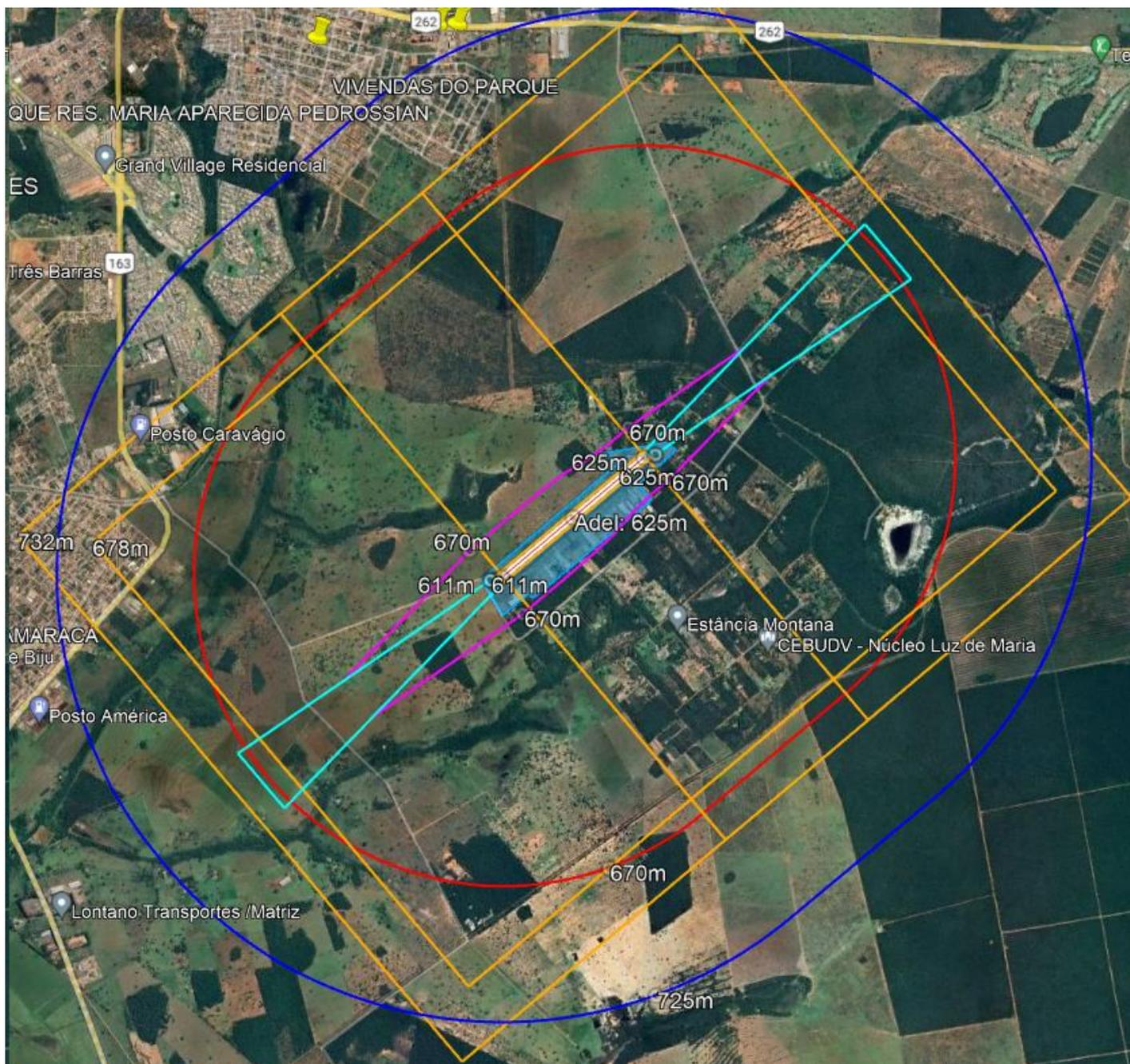
Figura 5-1 SSKG: objetos projetados no espaço aéreo e Superfícies Limitadoras de Obstáculos (OLS)
