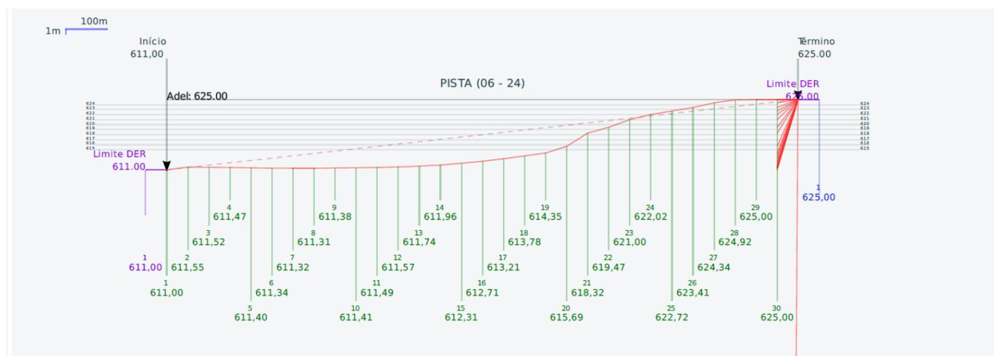
Figura 5-3 SSKG: perfil da pista de pouso e decolagem
