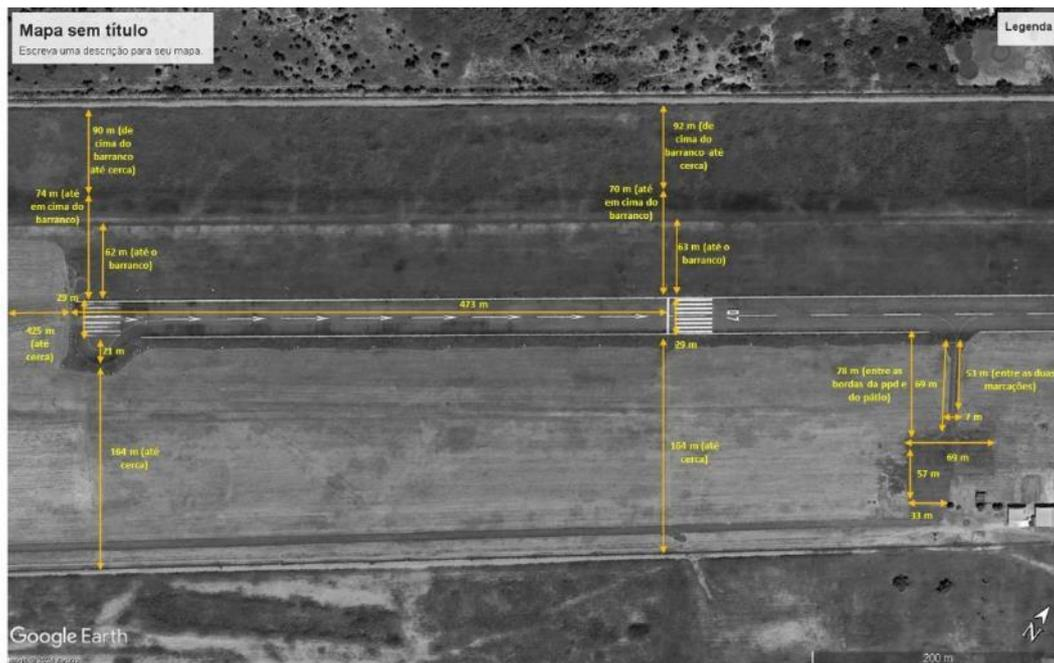
Figura 3-15 – Croqui de medidas do aeroporto de Três Lagoas – Parte I
