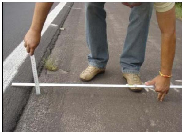
Figura 1-90 – Levantamento Degrau (Pista/Acostamento).
