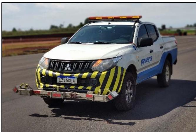
Figura 1-89 - Perfilômetro Laser.
