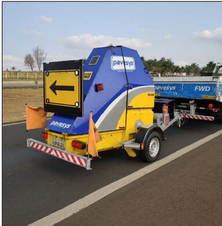
Figura 1-85 - Equipamento FWD Pavesys.
