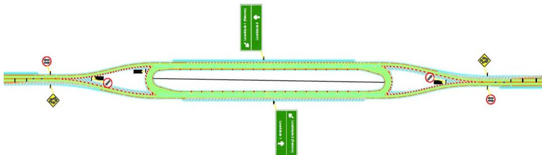
Figura 3-1 - Modelo de Retorno Alongado – Retorno Simples
