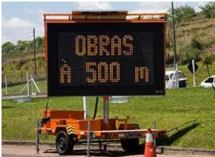
Figura 2.6 - Exemplo de painel móvel de mensagem variável.
