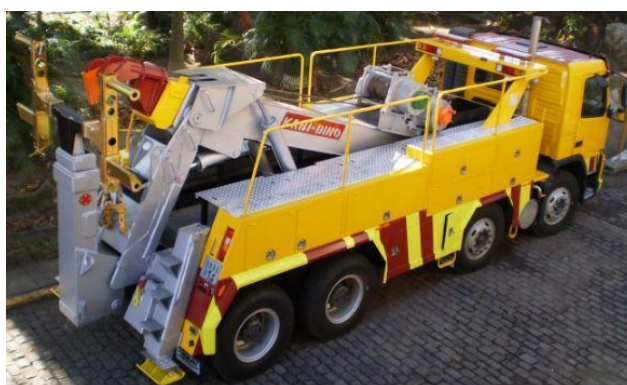
Figura 2.3 - Exemplo de caminhão guincho pesado.
