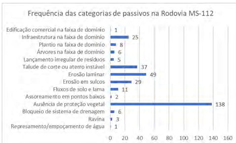
*Figura 3-71 – Frequência das categorias de passivos na Rodovia MS-112*
