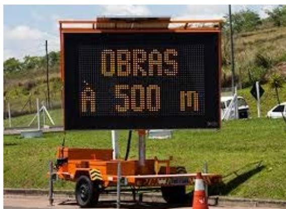
Figura 2.7 - Exemplo de painel móvel de mensagem variável.
