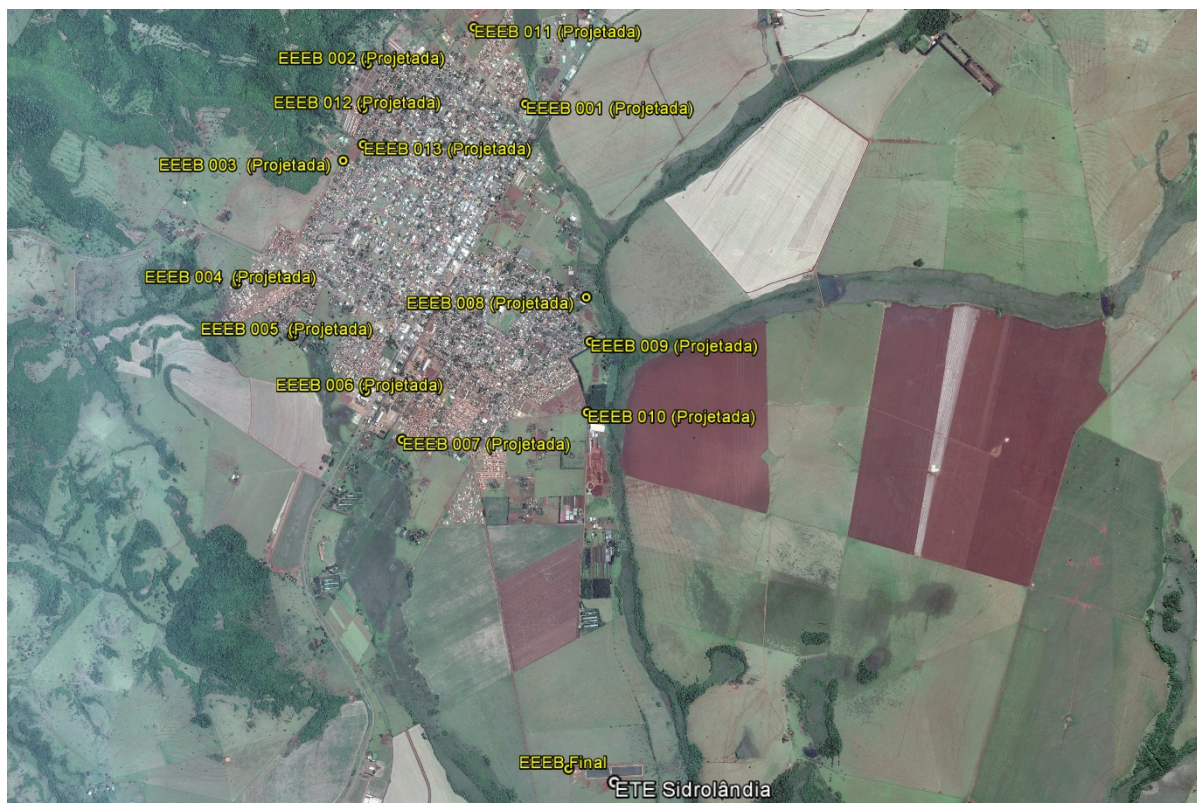
Figura 1: Localização das Unidades Operacionais existentes e projetadas na cidade de Sidrolândia, MS.
