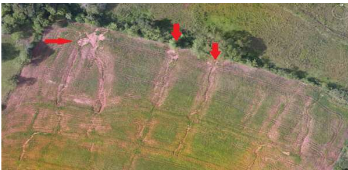
Figura 11: Início de processos erosivos na área pretendida para a ETE Fátima do Sul Projetada, Fátima do Sul, MS.
