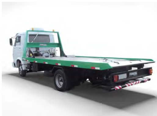
Figura 2.2 - Exemplo de caminhão plataforma para veículos leves.
