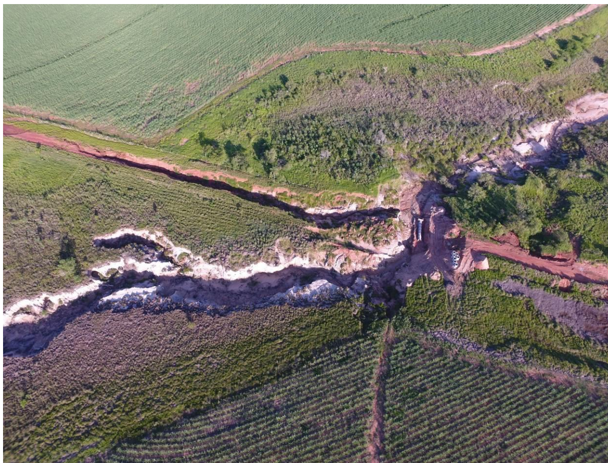
Figura 5: Vista aérea da voçoroca que danificou o emissário da ETE Nova Esperança, distrito de Nova Esperança, MS
