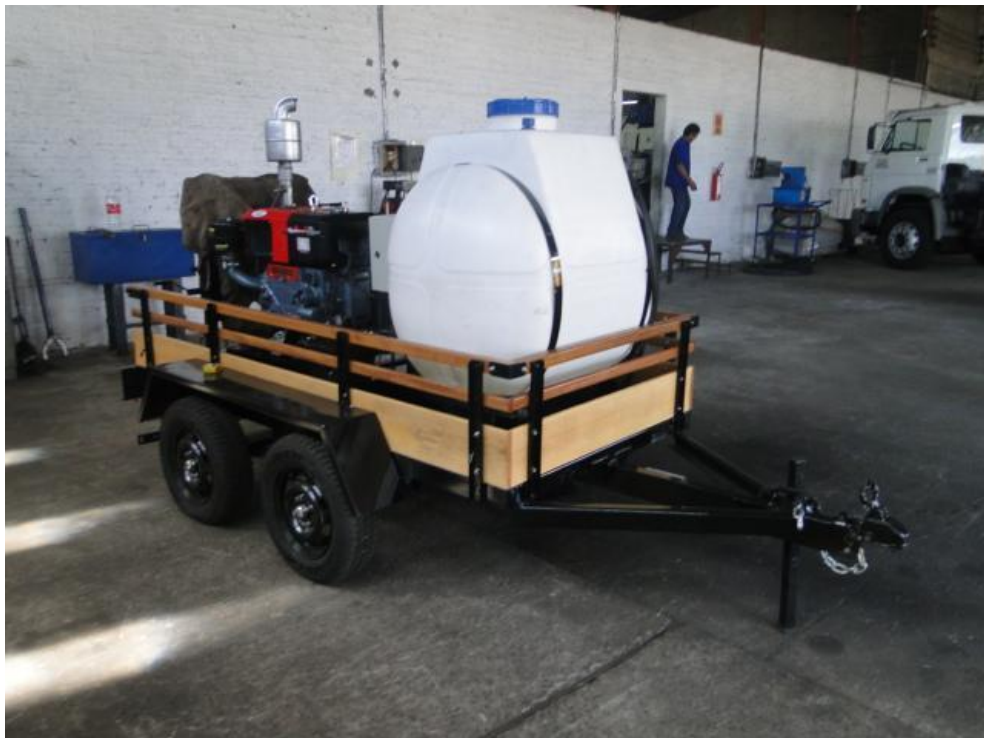
Figura 10: Exemplo de hidrojateamento instalado em carretinha
