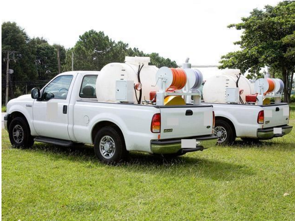
Figura 9: Exemplo de hidrojateamento instalado em veículo pick-up
