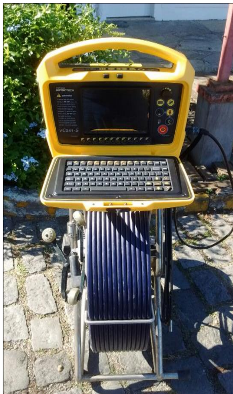
Figura 8: Exemplo de equipamento de filmagem interna de tubulações de esgoto
