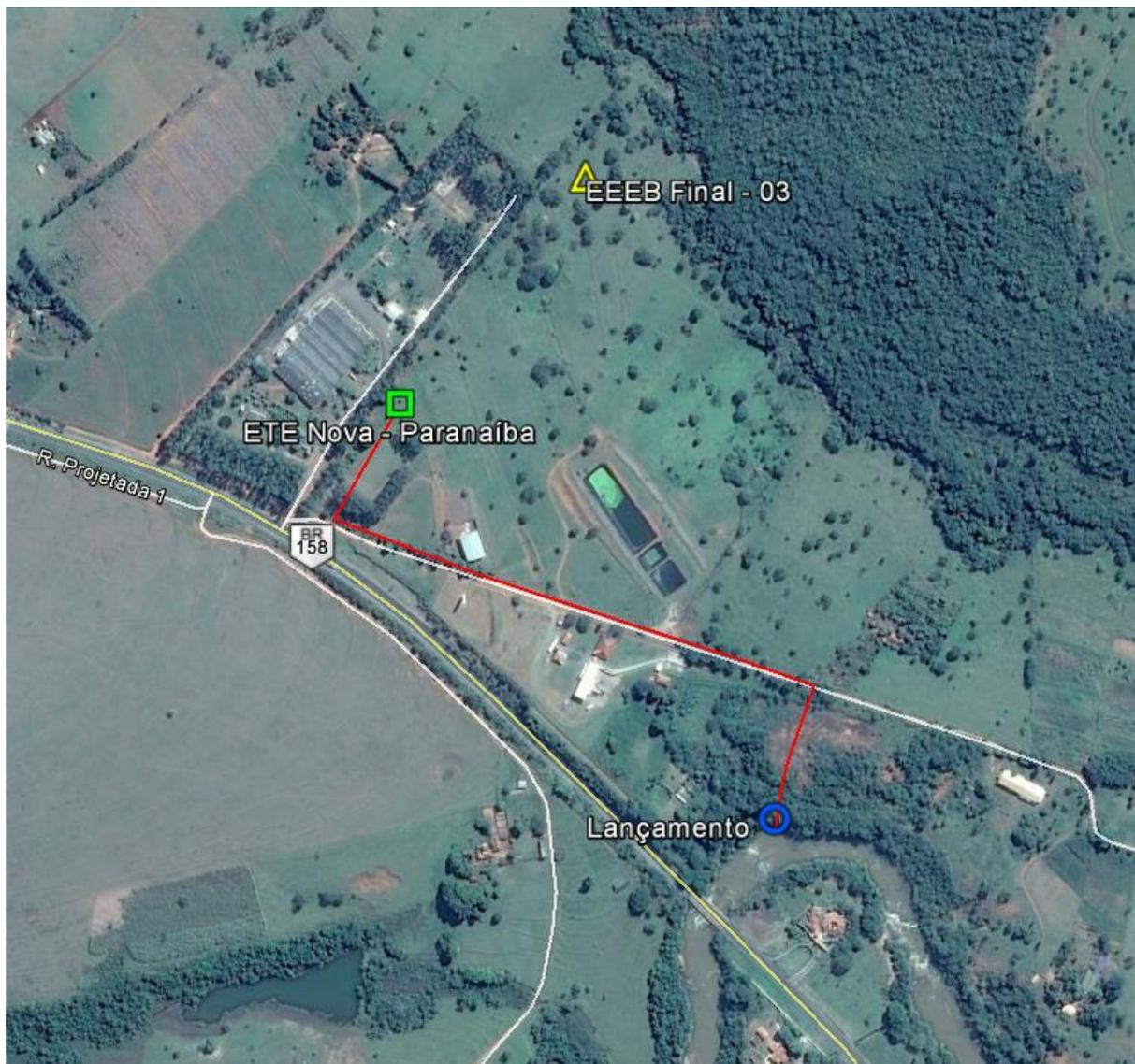
Figura 1 - Emissário de recalque de esgoto tratado e ponto de lançamento.
