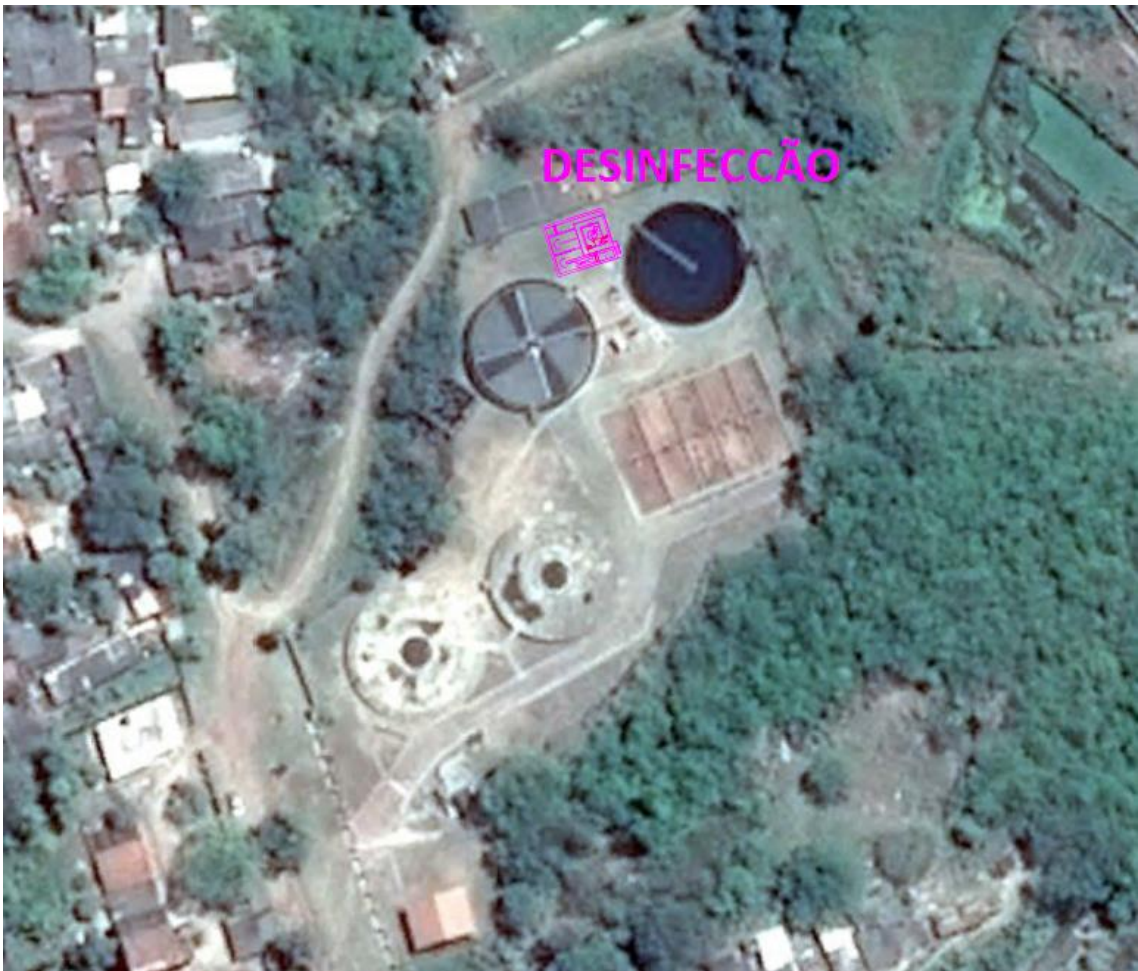
Quadro 15 - Locação do Tanque de Contato.
