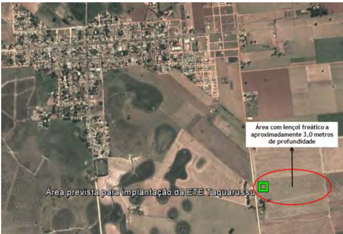
Figura 6: Região com nível de lençol freático a 3,00 metros de profundidade (Fonte: Google adaptado).
