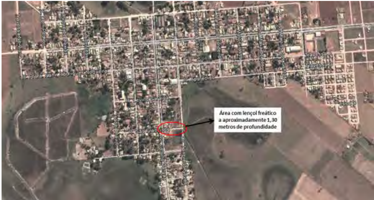
Figura 5: Região com nível de lençol freático a 1,30 metros de profundidade (Fonte: Google adaptado).
