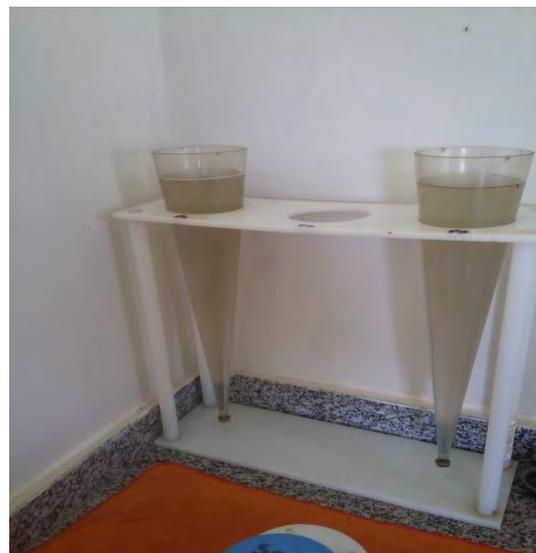
**Figura 29:** Amostras no período de decantação durante o ensaio de sólidos sedimentáveis no cone Imhoff, à esquerda amostra de esgoto bruto e a direita, esgoto tratado da ETE Santa Rita do Pardo.
