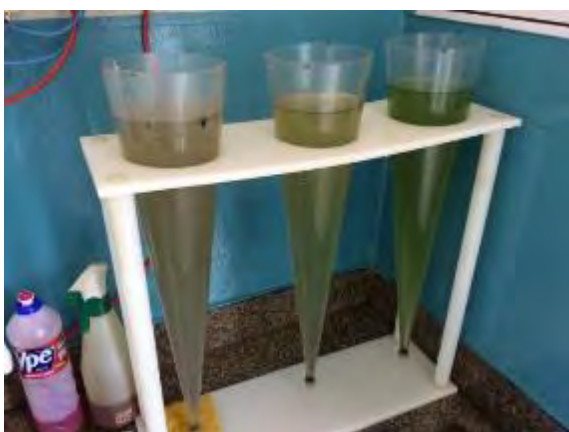
Figura 27: Vista das amostras dos efluentes do processo nos cones Imhoff, da esquerda para direita: Esgoto Bruto, saída das Lagoas Facultativas e saída das Lagoas de Maturação da ETE Porto Murinho.
