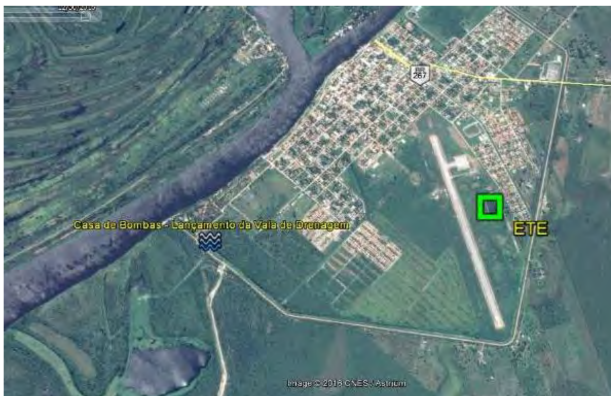
Figura 35: Localização da casa de bombas para lançamento das águas da vala de drenagem da cidade de Porto Murtinho para o Rio Paraguai.
