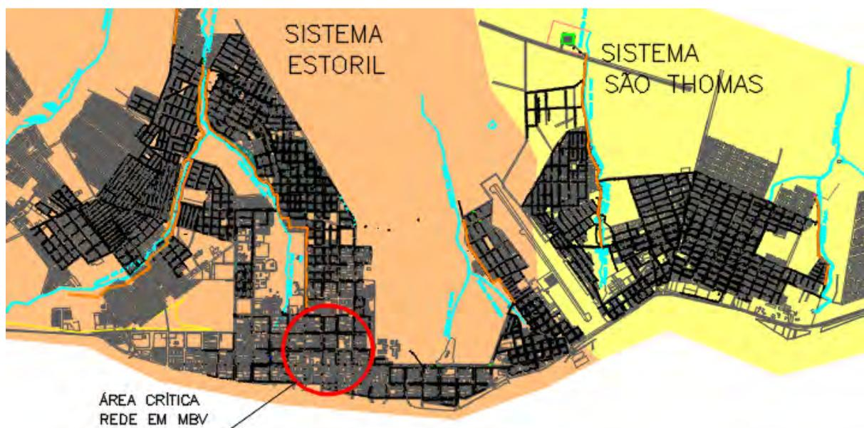
**Figura 5: Área crítica com tubulação de Manilha de Barro Vitrificada.**
