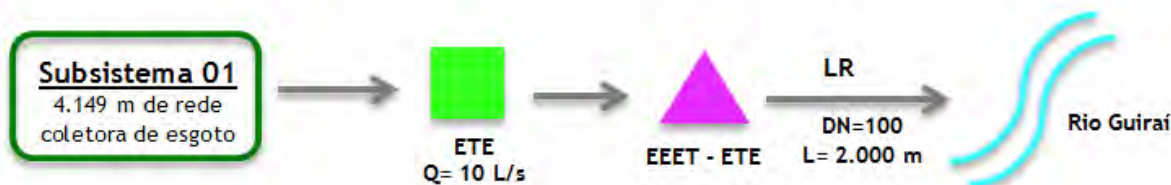
Figura 1: Fluxograma do SES existente de Nova Esperança.
