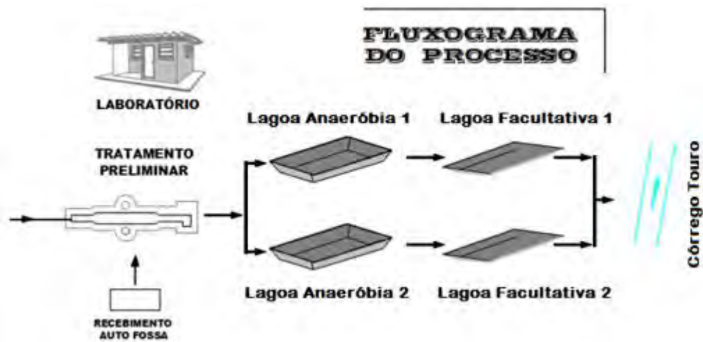
Figura 9: Fluxograma do Processo da ETE Ipê
