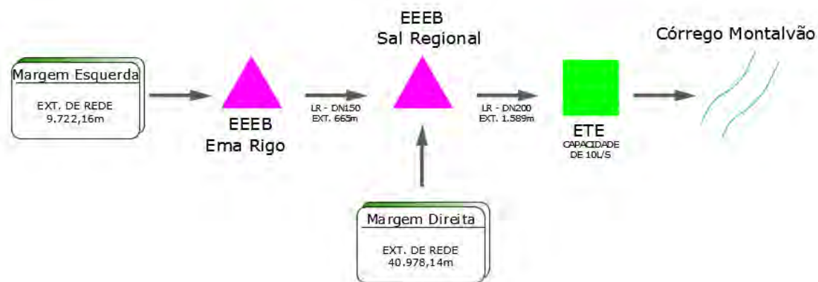
Figura 2: Fluxograma esquemático – SES Maracaju
