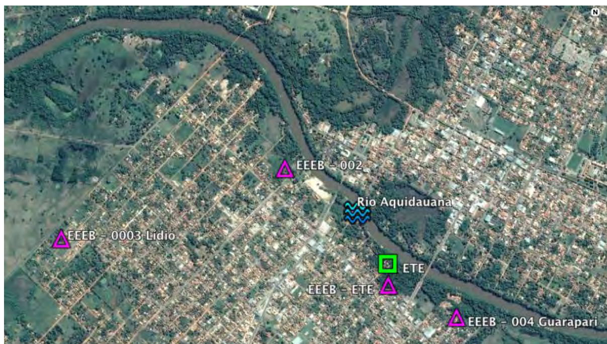
Figura 4: Localização das elevatórias e estação de tratamento de esgoto.
