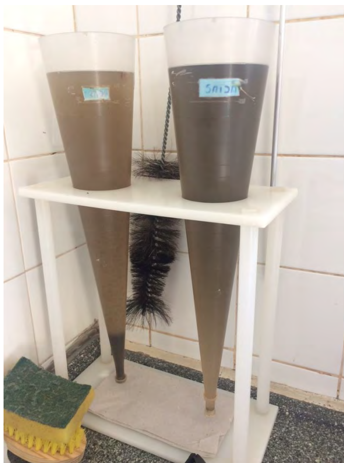
Figura 23: Cone de Imhoff - Entrada e saída do reator
