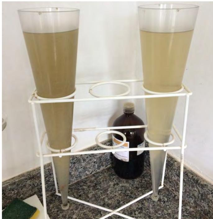
**Figura 16: Amostras no período de decantação durante o ensaio de sólidos sedimentáveis no cone Imhoff, à esquerda amostra de esgoto bruto e a direita, esgoto tratado na ETE Caracol.**
