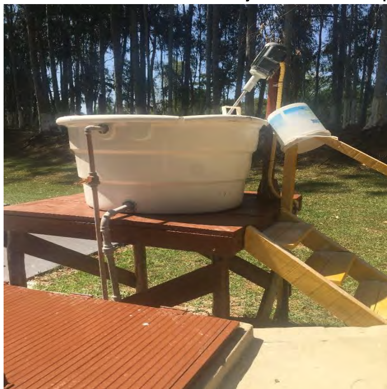
Figura 24: Tanque de preparo da solução de cal.
