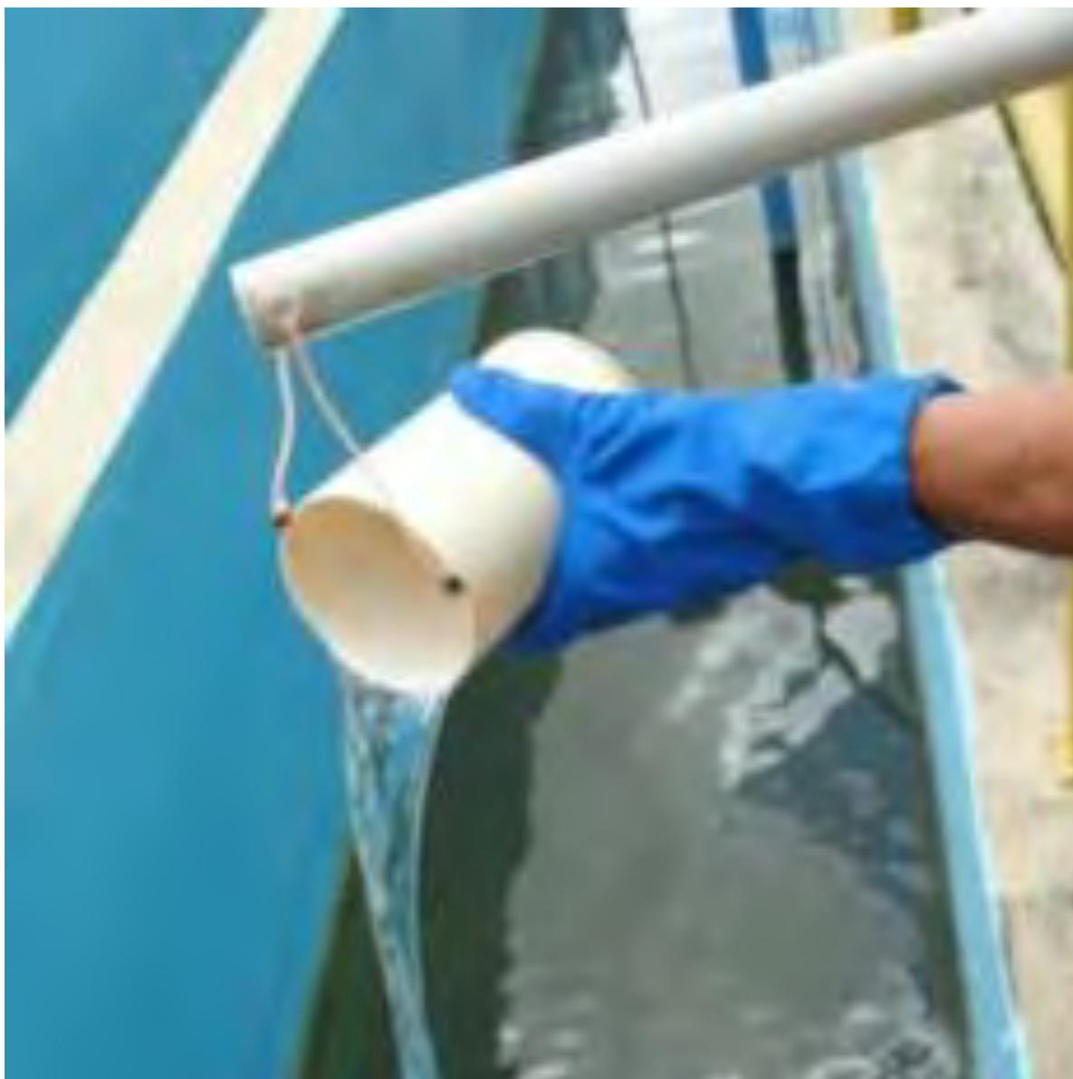
**Figura 35: Efluente coletado no final do tanque de contato da ETE Bonito.**
