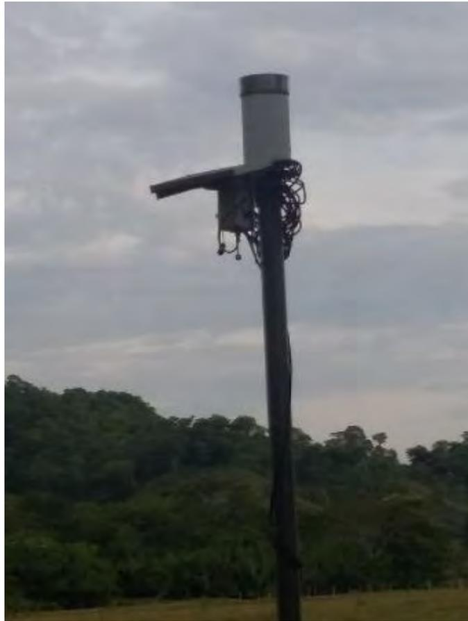
**Figura 43: Equipamento de medição de vazão existente próximo ao ponto de lançamento no Córrego Taquarussu (fora de uso).**
