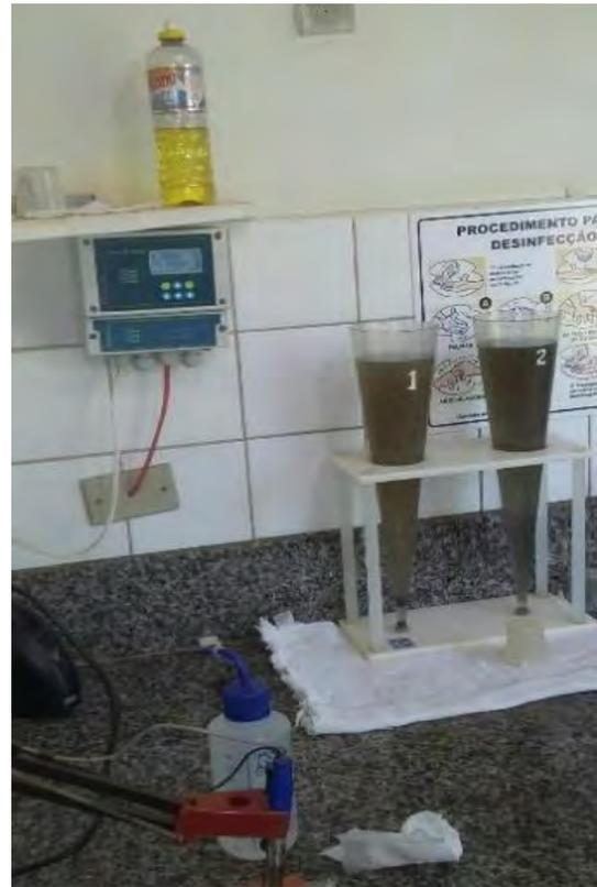
**Figura 17: Vistas das amostras do efluente (ponto 01 e ponto 02) ETE Bataguassu.**
