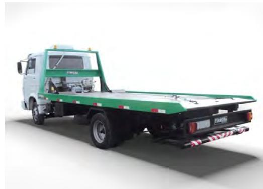
Figura 2.2 - Exemplo de caminhão plataforma para veículos leves.
