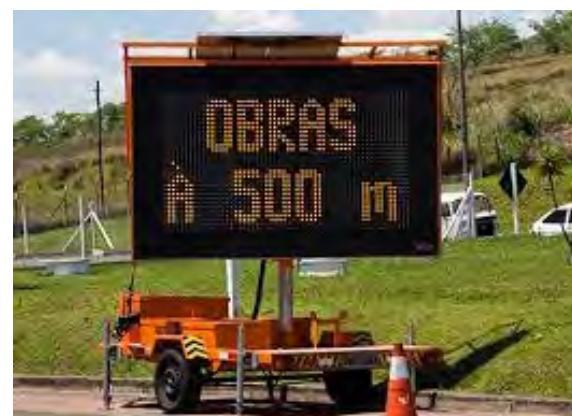
Figura 2.8 - Exemplo de painel móvel de mensagem variável.
